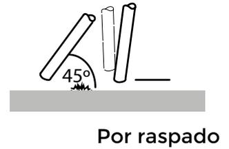
La soldadura MMA se refiere a soldadura con electrodos revestidos. El arco eléctrico funde el electrodo y el revestimiento forma una capa de protección (escoria). Si para abrir el arco, el electrodo se presiona contra la pieza a ser soldada, el electrodo se funde y adhiere en la pieza haciendo imposible la soldadura. Existen dos formas de encender el arco correctamente, por golpeo o por raspado siendo esta última la más utilizada.
