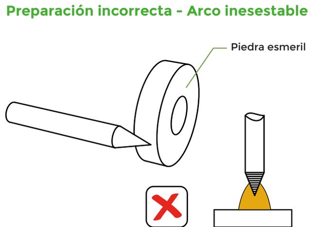
El afilado deberá hacerse siempre en el sentido de giro de la piedra de afilado. Esto ayuda a direccionar el arco hacia el extremo del electrodo.
