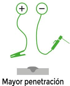
La conexión en polaridad directa se produce conectando el cable de pinza (con pinza porta electrodo) al polo negativo (-) de la fuente de soldadura y el cable de masa (con pinza de masa) al polo positivo (+) de la fuente. El arco eléctrico concentra el calor producido en la pieza favoreciendo la fusión y penetración en la misma.
