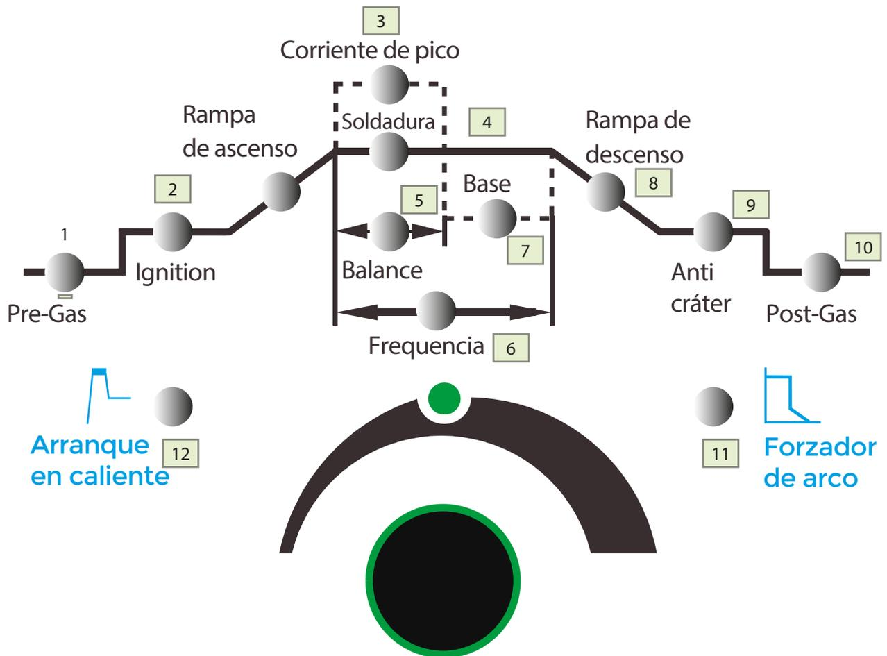
**1- Pre gas:** La función de pre gas permite establecer un flujo de gas previo a iniciar el arco eléctrico, para generar una limpieza de la zona a soldar y establecer una atmósfera de protección segura. El valor se expresa en segundos y se visualizará en el display.
