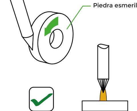
El afilado deberá hacerse siempre en el sentido de giro de la piedra de afilado. Esto ayuda a direccionar el arco hacia el extremo del electrodo.
