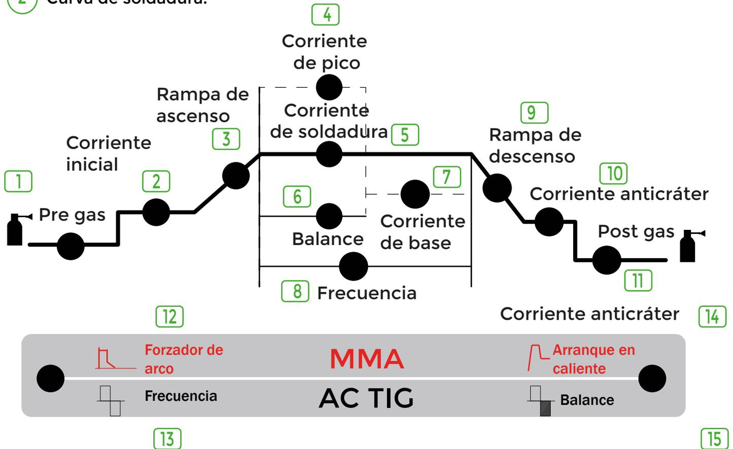
**1- Pre gas:** La función de pre gas permite establecer un flujo de gas previo a iniciar el arco eléctrico, para generar una limpieza de la zona a soldar y establecer una atmósfera de protección segura. El valor se expresa en segundos y se visualizará en el display.
