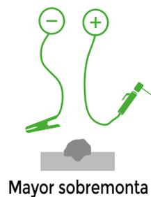
La conexión en polaridad inversa se produce conectando el cable de pinza (con pinza porta electrodo) al polo positivo (+) de la fuente de soldadura y el cable de masa (con pinza de masa) al polo negativo (-) de la fuente. El calor del arco eléctrico se concentra sobretudo en el extremo del electrodo, logrando mayor capacidad de aporte. Cada tipo de electrodo necesita un tipo específico de curso de corriente (CA o CC) y en el caso de corriente CC una polaridad específica.
